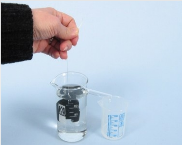
Inmersión de un cuerpo en el vaso de desbordamiento
